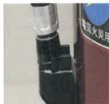
× 消火薬剤の漏れ
