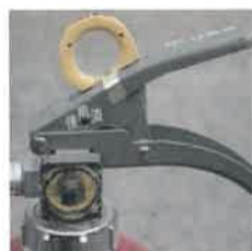
× 表示装置の脱落
