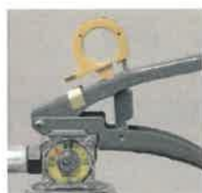
× 安全栓の抜けかけ
