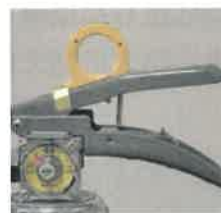
× レバー支えの脱落
