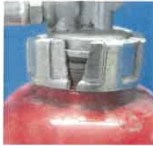
× キャップの破損
