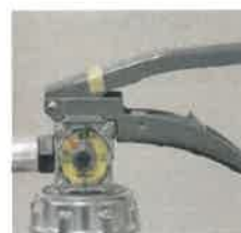
× 安全栓の脱落
